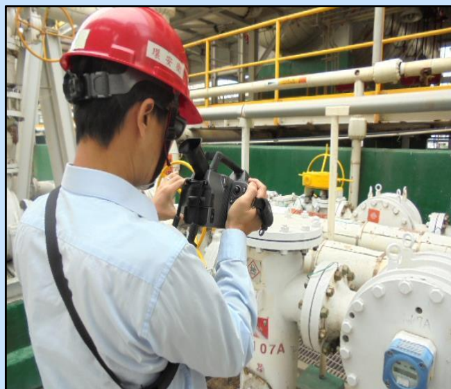
以手提式紅外線熱顯像儀進行VOC自主檢測
