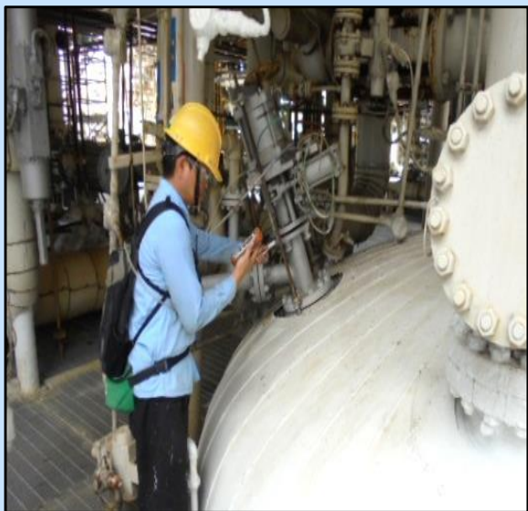
以攜帶式氣體偵測器進行自主檢測
