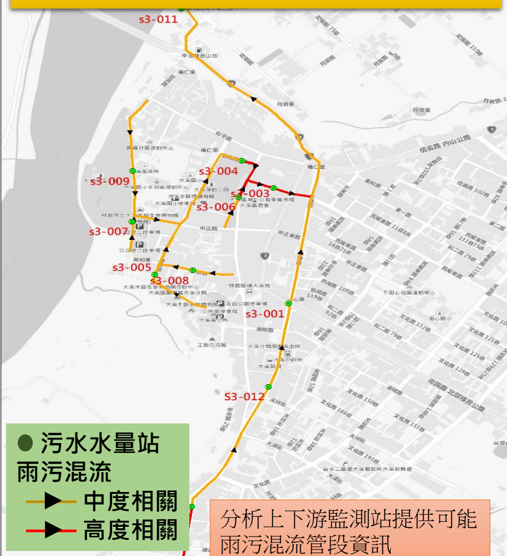
0702豪雨事件大溪污水下水道雨污混流狀況
