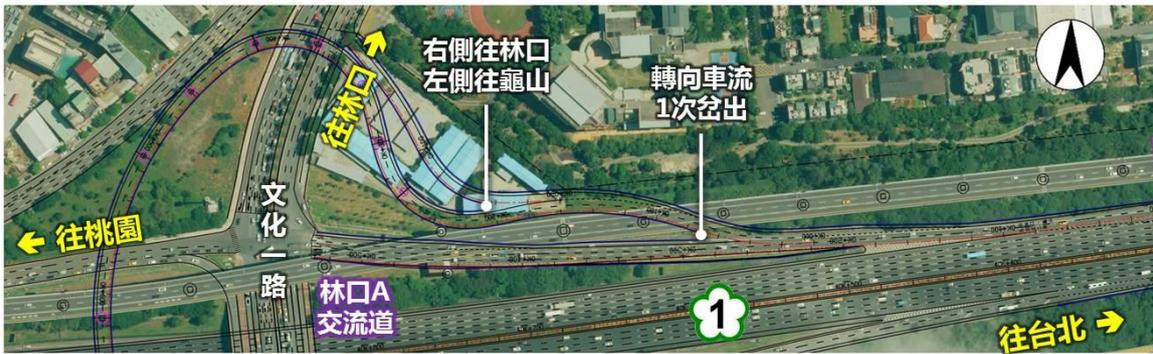
圖 3.3-2 轉向車流採 1 次右出方案平面圖
