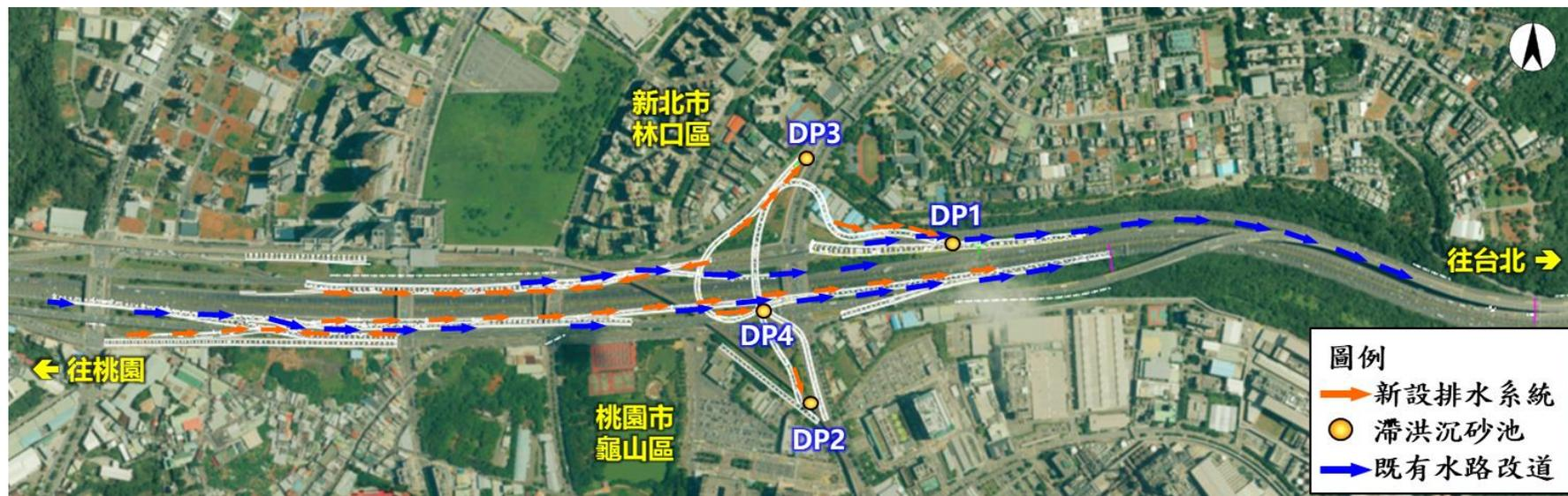
圖 4.1-4 排水系統配置圖
