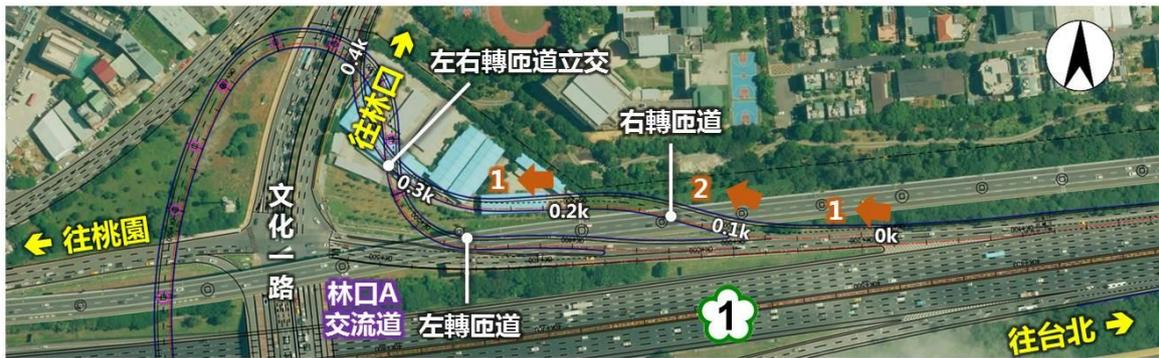
圖 3.3-6 新設右轉匝道方案平面圖
