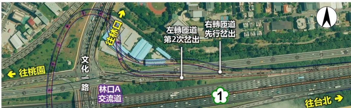
圖 3.3-3 轉向車流採 2 次右出方案平面圖
