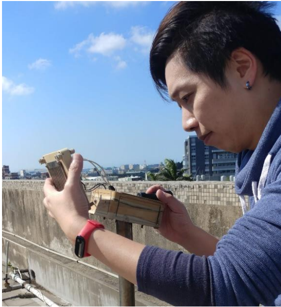
圖 13. 更換蘆竹站之雨水感應 sensor
