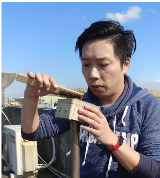
圖 14. 大園站 sensor 略微生鏽情況並進行清潔
