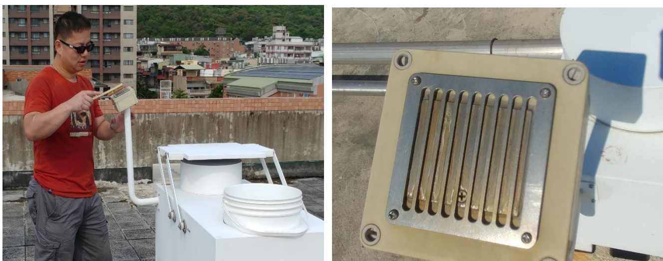
圖 9. 桃園站內部查核時清潔採樣器 sensor 剪影
