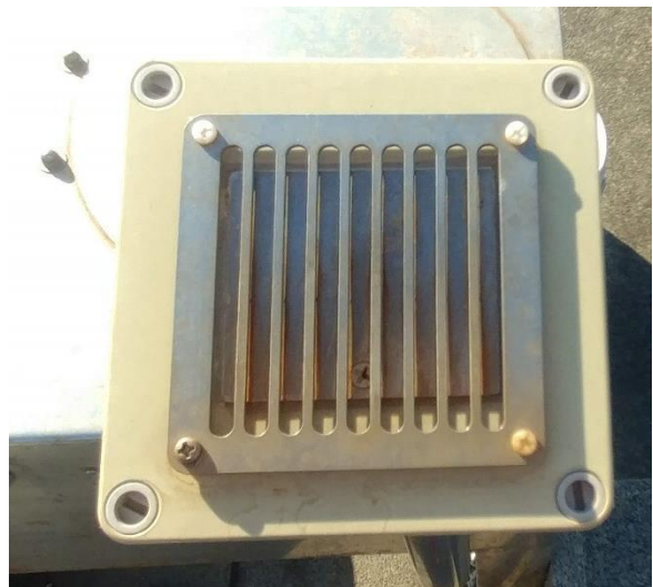
圖 14. 大園站 sensor 略微生鏽情況並進行清潔
