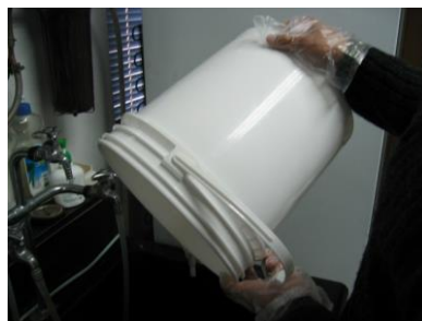
(e) 500ml 清洗採樣桶 1 次 (f) 倒乾
