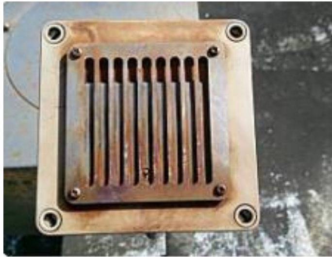
圖 12. 新屋站雨水採樣器 sensor 未更換前生鏽之情況
