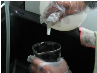
(a)200ml 清洗量杯 3 次 (b) 倒乾
