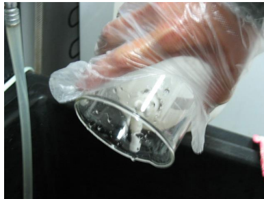
(a)200ml 清洗量杯 3 次 (b) 倒乾
