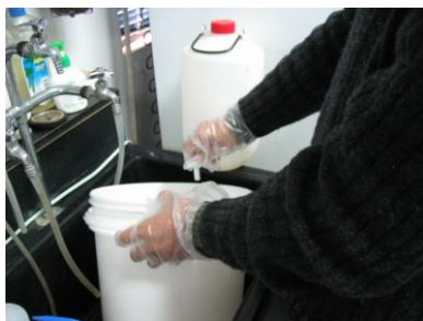
(e) 500ml 清洗採樣桶 1 次 (f) 倒乾
