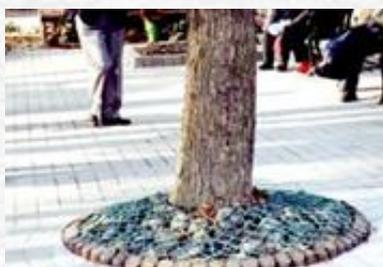
圖4.7-16 軟性材質的植穴保護設施實例
